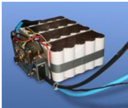
Lithium Ion Mangan pack 7S5P = 26,6V; 15A Toepassing: startaccu voor kleine vliegtuigen met piekbelasting tot 300A
